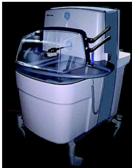
图1 充分整合的小动物成像系统，可以进行高级定量以及容积融合。
